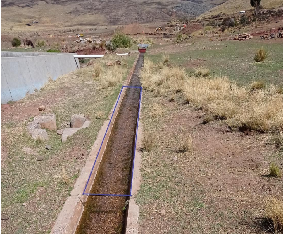
Figura 13. Determinación del caudal mediante método del Flotador.
